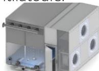
Enveloppe : panneaux rigides autoportants, avec double ou quadruple pli sur les quatre côtés du panneau (de conception **JACIR**) permettant si besoin l'insonorisation du corps de tour. L'assemblage est réalisé par rivets Inox étanches (puissance et uniformité du serrage). Ni soudure, ni vis pour les panneaux en contact avec l'eau. La gamme **DTC** est prévue pour un transport optimisé avec l'assemblage final de ses 2 modules.
